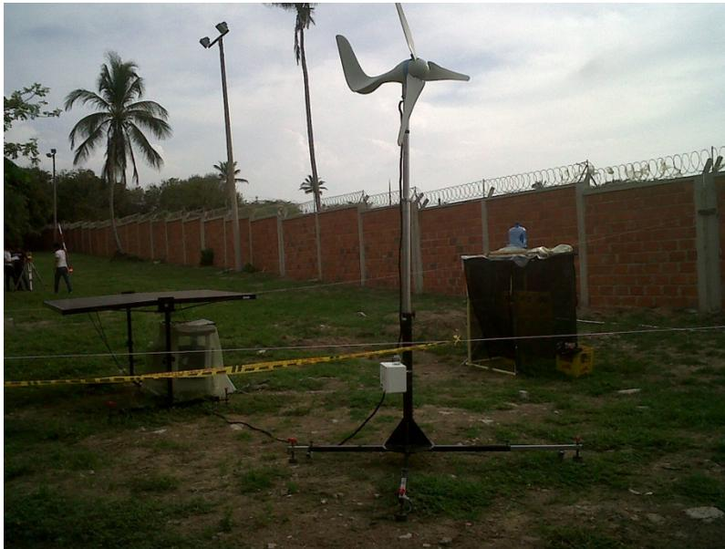
**Figura 3:** Sistema aerogenerador-panel solar-caja de mando-invernadero.
