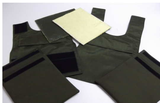
Figura 20. Sistema de protección balística Nivel IIIA Desarrollado en la EMAVI
