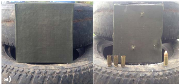
Figura 14 Pruebas balísticas Placa de blindaje 1
