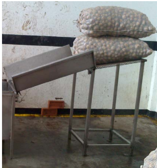
Figura 2. Mecanismo de alimentación
