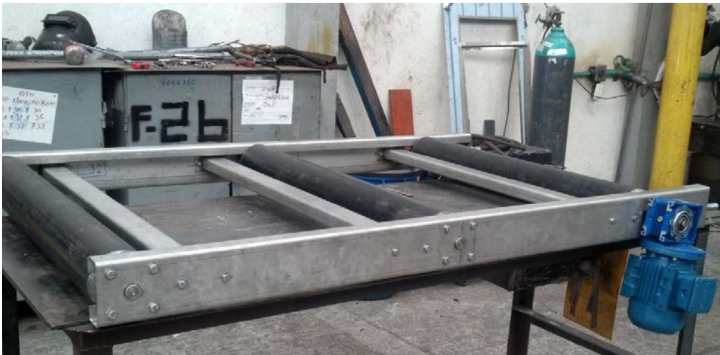
Figura 4. Rodillos implementados en los mecanismos de transporte
