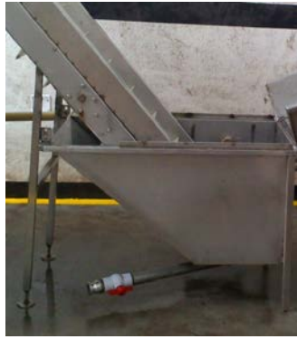
Figura 5. Mecanismo de prelavado
