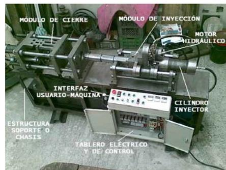
Figura 3. Máquina inyectora de plásticos.
