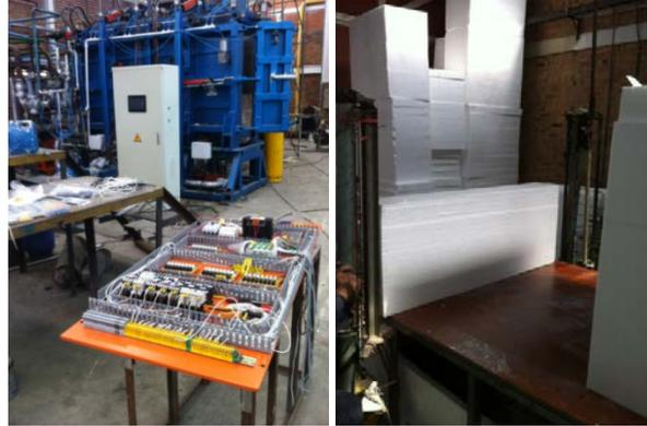
Figura 2. Máquina de expansión automatizada y producto final.
