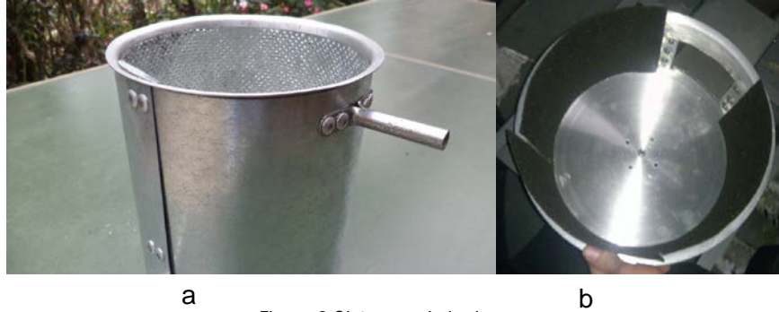
Figura 2 Sistema pelado de papa
