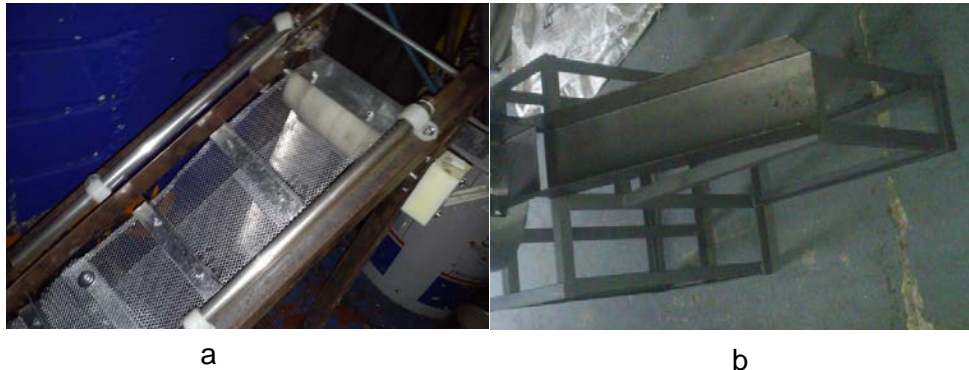
Figura 3 Sistema de transporte de papa
