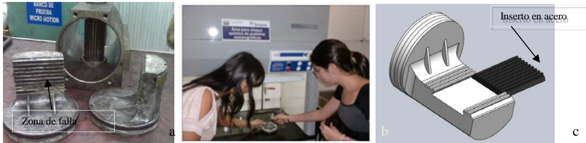
Figura 2. a) Falla en la zona estriada del actuador; b) Caracterización del aluminio por los estudiantes y c) Interesante solución innovadora y creativa, implante en el actuador
