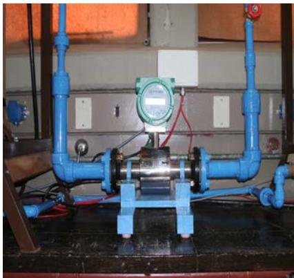
Figura 3: Caudalímetro FIT-101
