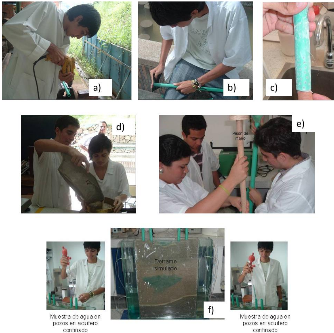
Figura 1 a) Preparación del material para los pozos, b) Pulida del material de pozos, c) Instalación de la malla tipo filtro, d) Ajuste al material granular, e) Llenado del tanque, f) Pruebas de funcionamiento hidráulico del acuífero
