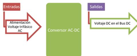
7. Plantean los principios que rigen el trabajo de cada uno de los componentes. Para el ejemplo se revisan en un libro de electrónica de potencia los conceptos de un convertidor de AC-DC.
