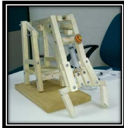
El manipulador debe ser de dos grados de libertad accionados con elementos hidráulicos y además acoplar una pinza para el agarre de piezas. Para efectos de prueba se debe agarrar una esfera de papel y transportarla de un lugar a otro para dejarla en una cesta. Adicionalmente se informa sobre las especificaciones en cuanto a los materiales sugeridos para la elaboración del mismo, así como el presupuesto asignado para la consecución del diseño propuesto.
