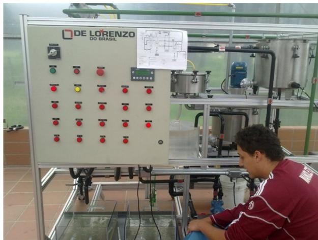
Fig 2. Estudiante operando la Planta piloto de biodiesel
