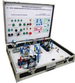
Figura 3. Equipo construido para implementar la guía GEMMA programada en GRAFCET
