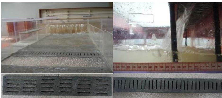
**Figura 7.** Ensayos de eficiencia de las rejillas de concreto
