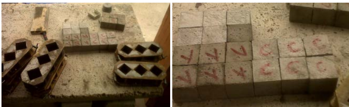
Figura 1 Preparación de la formaleta, organización del área de trabajo y especímenes etiquetados
