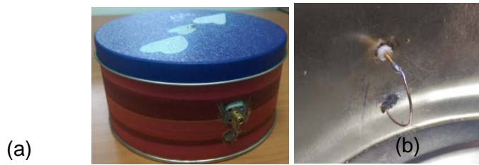
Figura 2. a) Cavity resonante usando una caja de galletas; b) Excitación por acople magnético
