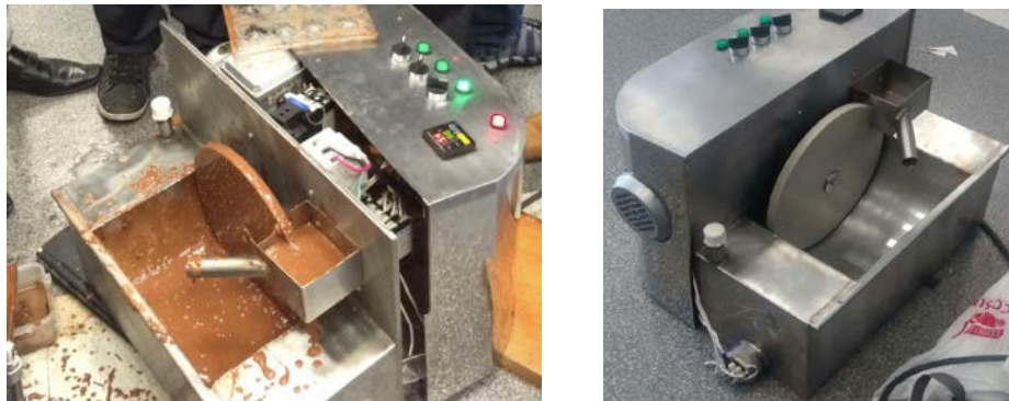
Figura 3. Dosificador de chocolate a la temperatura ajustada.
