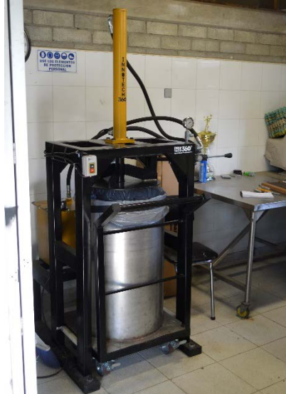
Figura 7. Máquina compactadora de residuos sólidos diseñada y construida, y que se encuentra en funcionamiento en el Centro de Acopio del Núcleo el Volador de la Universidad Nacional de Colombia Sede Medellín.
