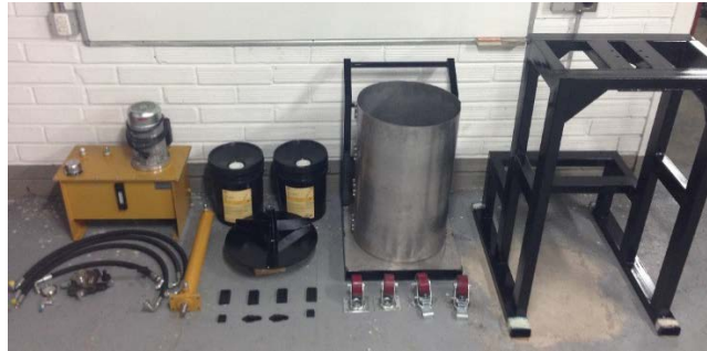
Figura 6. Componentes desmontadas de la máquina compactadora de residuos sólidos.
