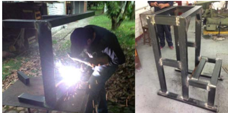
Figura 5. Proceso de soldadura de la estructura principal del equipo de compactación.
