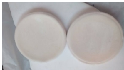
Figura 3. Esmalte aplicado en la pasta
