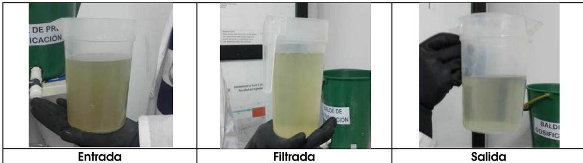
Fig 2. Comparación del agua residual a la entrada, en la mitad del proceso y a la salida de la planta piloto en el primer día.
