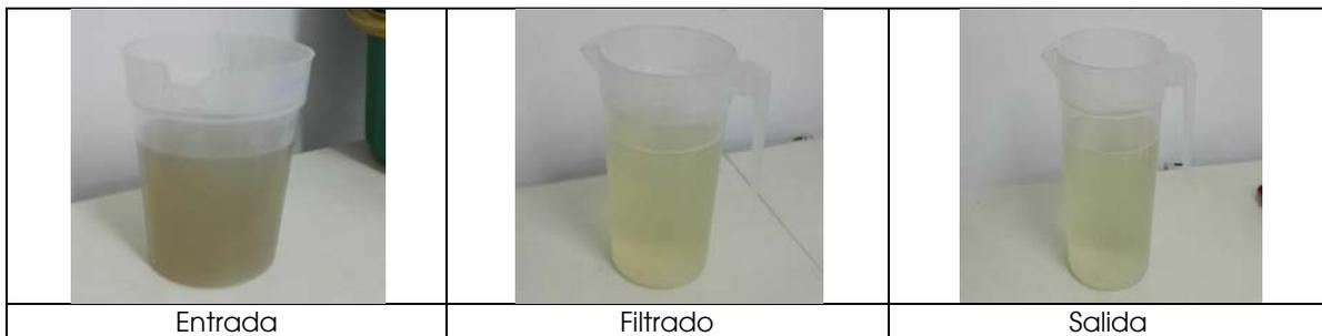
Fig 3. Comparación de aguas residuales desde la entrada del planta piloto hasta la salida en el segundo día.
