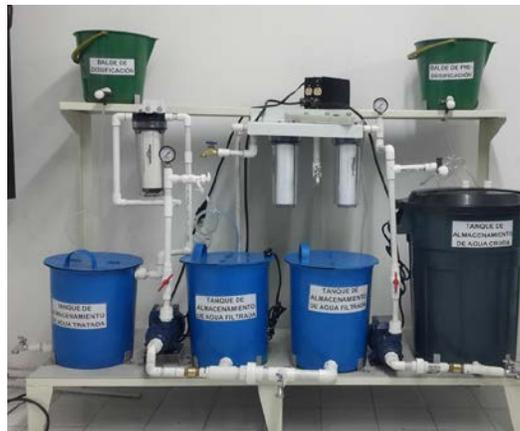
Fig 1. Planta piloto de membranas de filtración.
