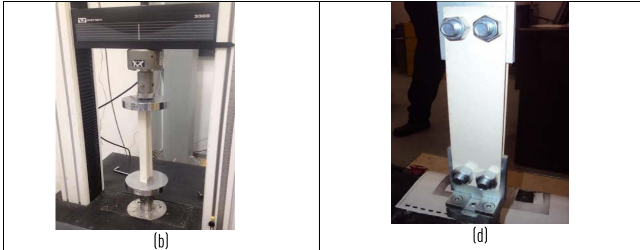
Figura 1. a) Montaje a cuatro puntos para elementos en flexión, b) Montaje para compresión, c) Sistema de conexiones con área constante 314.16\text{mm}^2 para mantener el esfuerzo de cortante similar en los modelos de papel que simulan las conexiones, d) Modelo de elementos conectados en tensión para dos pernos de 14.1\text{mm} de diámetro.
