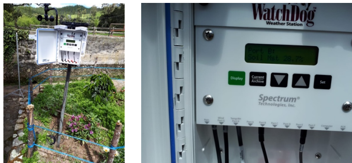
Figura 3 Estación metereológica Watchdog2000 instalada en el área del cultivo seleccionada.
