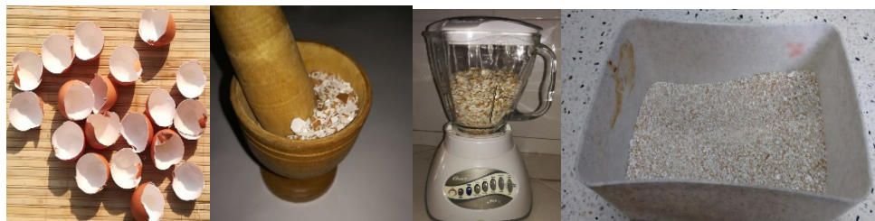
Figura 1. Proceso de preparación del cascarón de huevo (deshidratación, maceración y pulverización) Fuente: los autores
