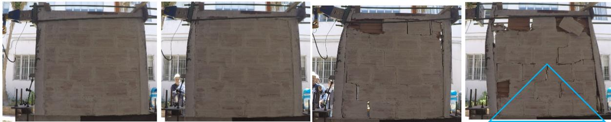
**Figura 7.-** Ensayo 1. Pórtico CFS con mampostería no estructural confinada.
