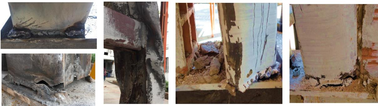
**Figura 8.-** Cordones de soldadura antes y después del ensayo en elementos CFS y pórtico.
