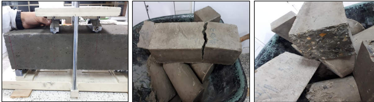
Figura 4 Ensayos en vigas
