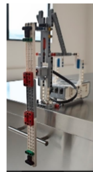
Figura 3.3: Montaje del péndulo físico con sensor de color para determinar el periodo de las oscilaciones.
