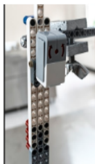
Figura 3.2: Montaje del péndulo físico con sensor de giro para determinar las oscilaciones amortiguadas.
