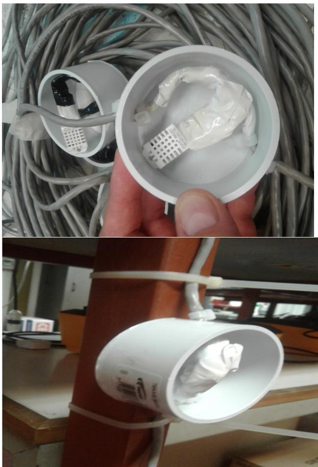
Fig. 5. Detalle de sensor de temperatura y HR%. Fig. 6. Fácil montaje de los sensores.
