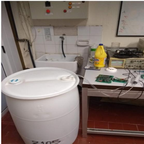
Fig. 7. Prueba de prototipo del equipo de medición de volumen de la merma por variación de presión
