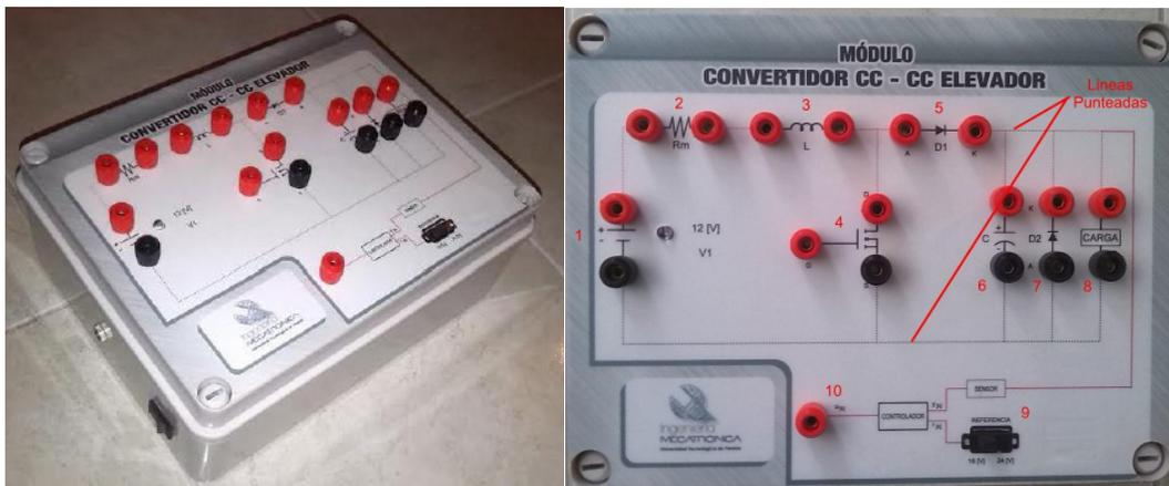
Figura 4. Prototipo del convertidor CC-CC elevador
