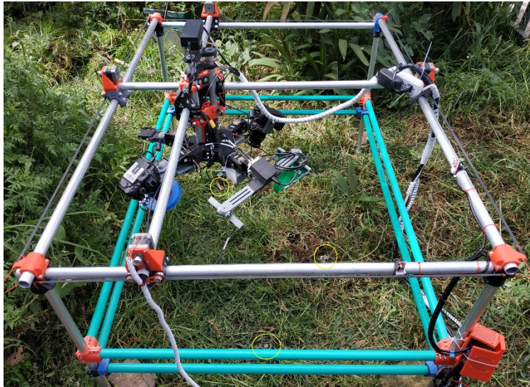
Figura 2. Estructura para realizar el barrido en una región específica, en los círculos amarillos se tienen los IED de prueba.
