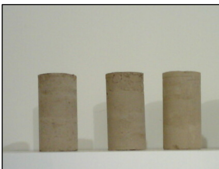
Figura 2. Muestras de suelo con 9%, 6% y 3% de cemento de izquierda a derecha.
