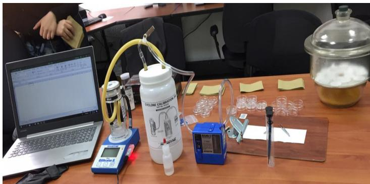
Universidad Libre de Colombia y se describen a continuación: bomba personal de muestreo GilAir, bomba de calibración, ciclón de nylon, filtros de policloruro de vinilo, porta filtros de celulosa, cassettes de tres cuerpos, pinzas y balanza analítica con sensibilidad de 0.00001g y calibración vigente
