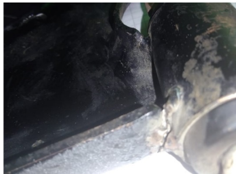
Figura 6. Fotografía de una de las fallas del brazo inferior (Acople entre el chasis y el brazo inferior)
